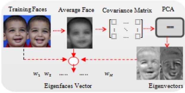
Fig. 4 : Eigenfaces Features Extraction.
