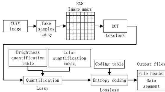
Fig. 4 JPEG Coding Flowchart
